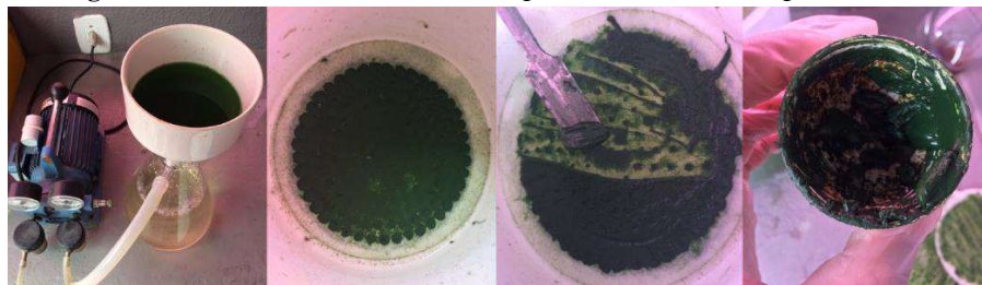
Figura 3. Processo de colheita de lodo algáceo sem o uso de coagulantes
